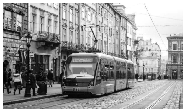
Рис.8. Трамвайний трисекційний вагон Електрон Т3L44 на площі Ринок у Львові
