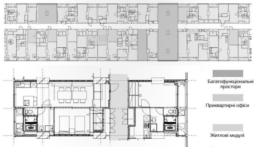
Рис. 6. Блоки, спроектовані Рікен Ямамото, організовані уздовж центрального проходу, але з використанням скляних дверей у кожному з блоків допускається більше світла [4].
