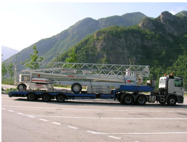
Рис. 7 - Перевозка быстромонтируемого башенного крана фирмы
