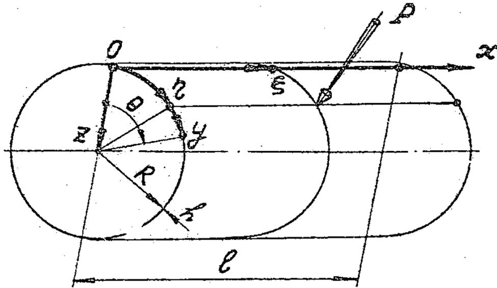
Рис. 1 - Сосредоточение усилия на цилиндрическую оболочку
