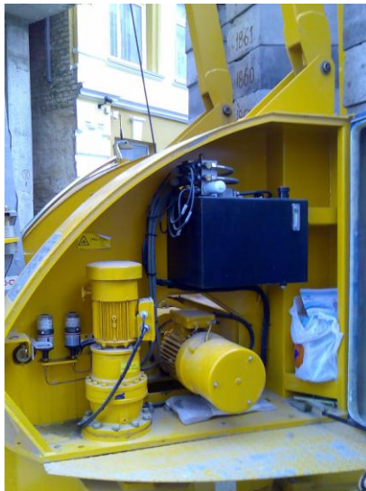
Рис. 11 - Маслостанция и приводы крановых механизмов
