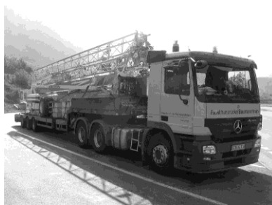
Рис. 2 - Перевозка быстромонтируемого башенного крана на одной машине
