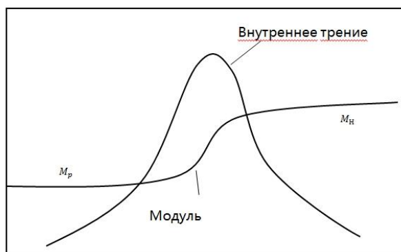
Рис. 4 – Зависимость внутреннего трения и динамического модуля от частоты колебаний
