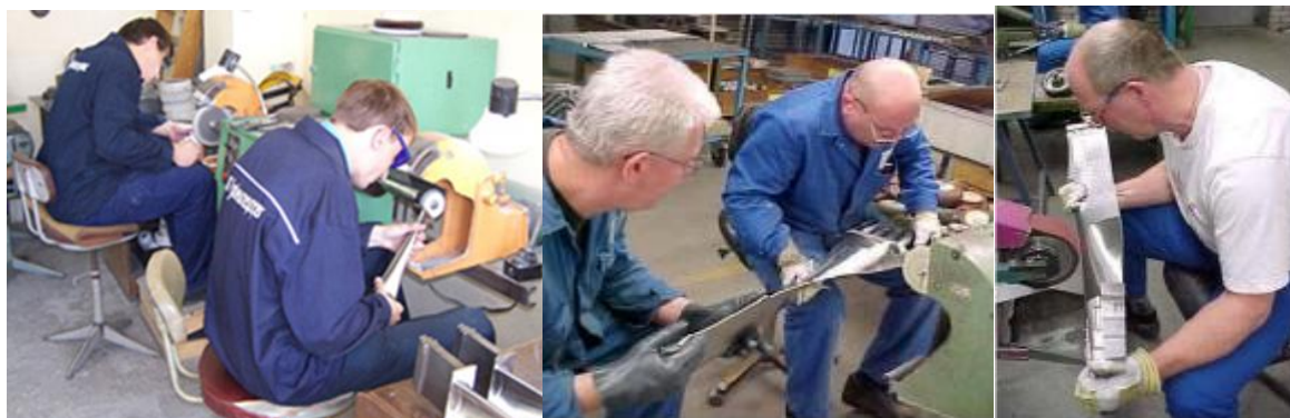
Рис. 2 – Ручной способ шлифования лопаток
