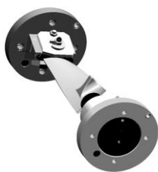
Рис. 5 – Станочное приспособление для крепления лопатки
