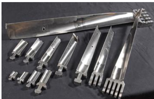
Рис. 1 – Лопатки турбин различных ступеней
