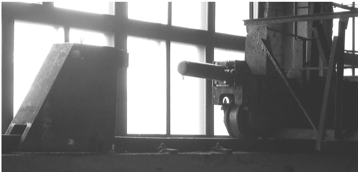
Рис. 6 – Елементи експериментальної захисної системи мостового крана 5т40
