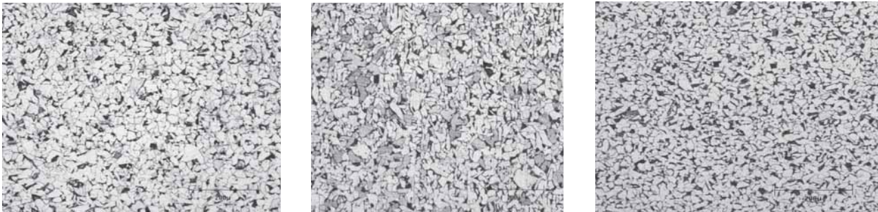
Фото 1 – Металлографические снимки образцов отобранных для исследований (8 бал зерна)
