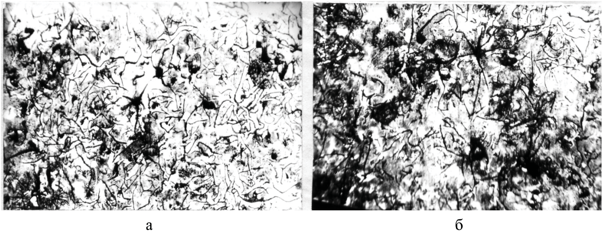
Рис. 1 – Микроструктура металла шва виконаного прутком А (а) и опытным прутком (б) x 450
