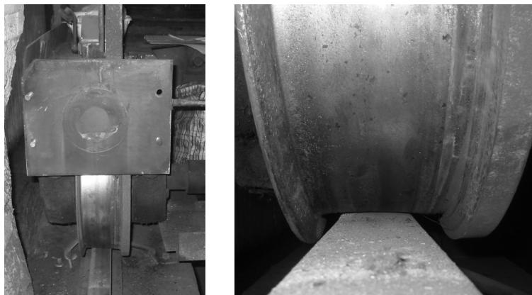
**Рис. 1 – Знос реборд ходового колеса**
