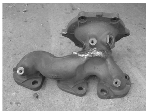
Рис. 2 – Приклади ремонтного зварювання чавунних деталей
