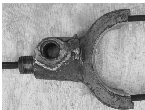
Рис. 2 – Приклади ремонтного зварювання чавунних деталей
