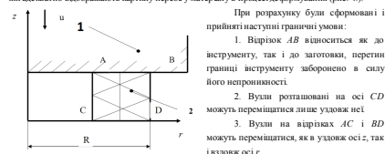
Рис. 3 – Розрахункова схема процесу опаді асиметричної заготовки: 1 - плита, 2 - заготовка, u - напрямове переміщення, R - радіус заготовки
