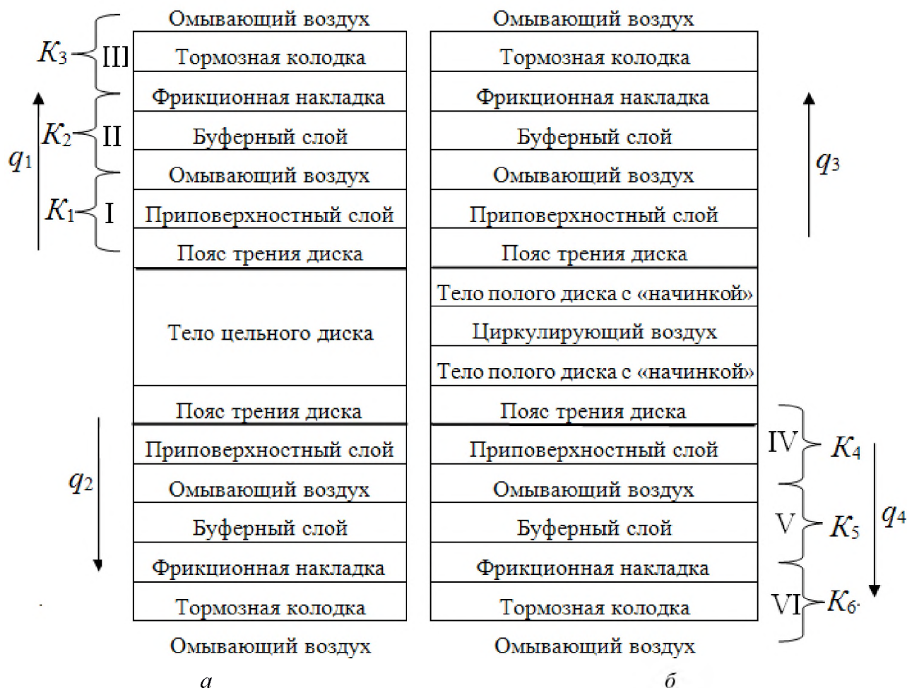
Рис. 2 – Многослойная тепловая модель пар трения дисково-колодочного тормоза с цельными (а) и самовентилируемым (б) дисками: q_1, q_2, q_3, q_4 – тепловые потоки; K_1, K_2, K_3, K_4, K_5, K_6 – коэффициенты теплопередачи; I, II, III, IV, V, VI – нумерация слоев, принимающих участие в теплообмене; жирными линиями показаны полированные поверхности разных тормозных дисков
