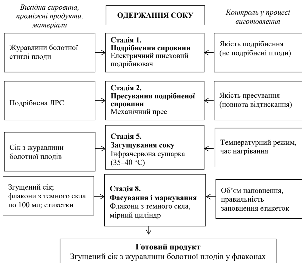
Рис. Технологічна схема одержання згущеного соку з журавлини болотної плодів.
