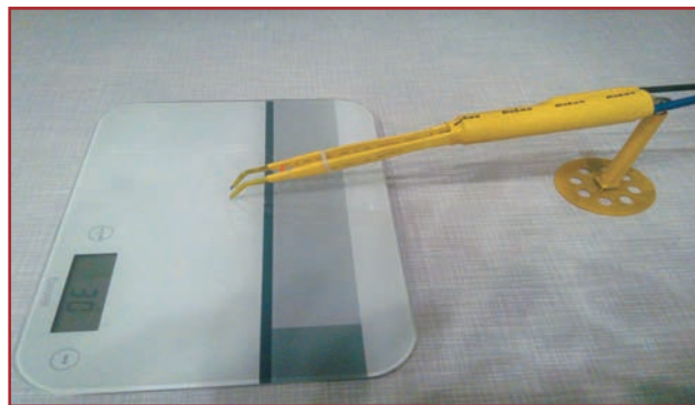
Рисунок 1. Биполярный электрод в виде биполярного пинцета особой формы весом 30 граммов
