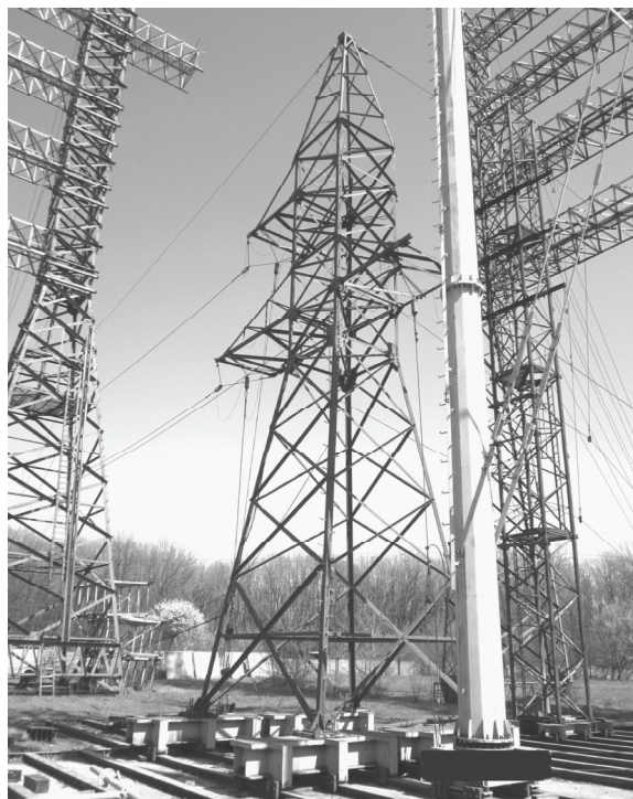
Рисунок 11. Испытание опоры У110-1 по I-й схеме загрузки.
