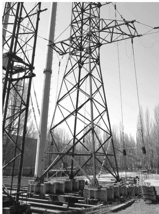
Рисунок 12. Испытание опоры У110-1 по III-й схеме загрузки.
