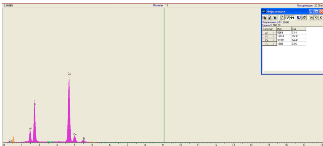
Рисунок 4 – Типова спектрограма, отримана від неметалевих вкраплень
