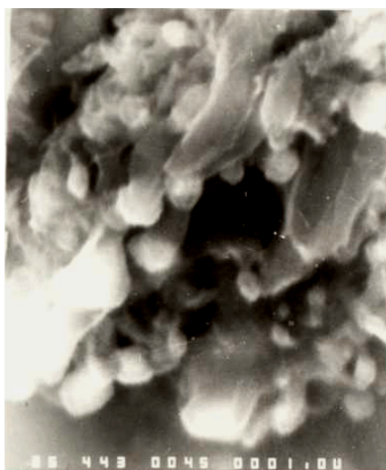
Рисунок 2 – Электронно-микроскопические исследования морфологических форм науглероженного катализатора (x 44000)
