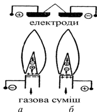
Рисунок 1 – Вплив електричного поля на позитивно та негативно заряджений пальник
