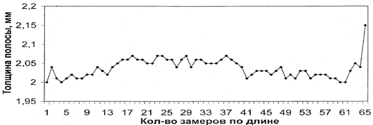
Рисунок 3 – Изменение толщины полосы 2 \times 1000 мм из стали марки 1пс, прокатанной с использованием «Coilbox» (длина сляба L = 9,3 м) (данные ОАО «Металлургический комбинат «Запорожсталь»)
