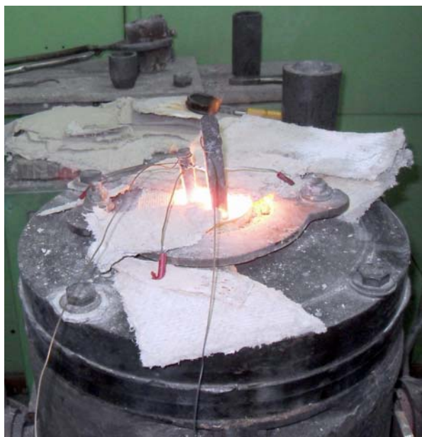
1 - печь Таммана; 2 - шахта печи (графит); 3 - подставка (графит); 4 - тигель с расплавом (графит); 5 - электрод-анод (графит); 6 - электрод-катод (графит); 7 - источник постоянного тока; 8 - стальная проволока; 9 - шлаковый расплав
