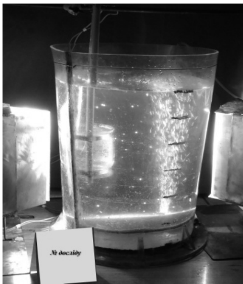
Рисунок 1 – Установка для моделювання гідродинаміки металу в ливарних ковшах під час комбінованого способу перемішування: а - фото установки; б - схема установки
