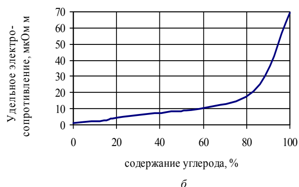
Рисунок 1 – Влияние содержания меди (а) и углерода (б) на удельное электросопротивление двухкомпонентного медно-графитового композита
