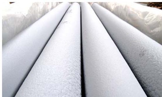
Рисунок 1 – Вид стрижнів полікристалічного кремнію, одержаних методом водневого відновлення трихлорсилану
