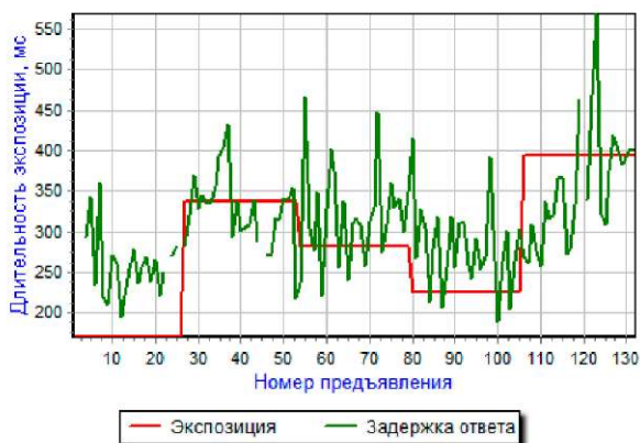
Рис. 3. Пример графика изменения экспозиции и реакции испытуемого в процессе выполнения программы испытаний.
