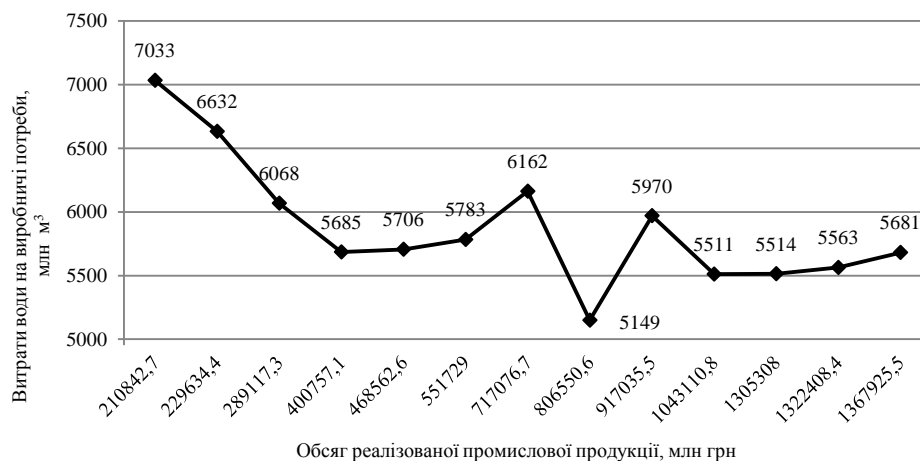
Рисунок 1 – Фактична залежність використання води на виробничі потреби від обсягу реалізованої промислової продукції в Україні за період 2001-2013 рр.
