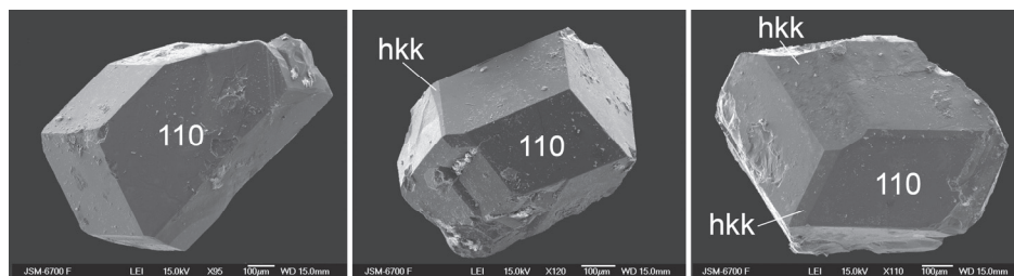
Рис. 1. Кристали андрадиту (електронний мікроскоп JSM-6700 F фірми Jeol).
