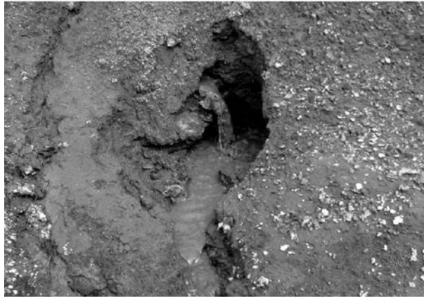
Рис. 7. Лінійно-ерозійний змив первинного гідроізоляційного прошарку з переходом глинистих мінералів у колоїдний розчин та винесенням за контур складування відвалів.
