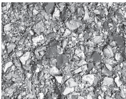
Рис. 5. Особенности флокулирования пироксена и граната с титаномагнетитом в классах различной крупности титаномагнетитовых концентратов (Гусевогорское месторождение, Урал): темно-серый – клинопироксен; белый и серый – титаномагнетит (изображение в упругоотраженных электронах). Сканирующий ЭМ JSM-6400, аналитик В. Филиппов (Сыктывкар).
