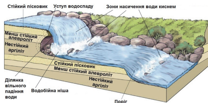
Рис. 8. Модель формування водоспадів і порогів та насичення води розчиненим киснем у флішовій формації басейну р. Стрий.
