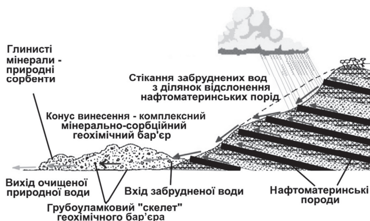
Рис. 4. Принципова схема комплексного мінерально-сорбційного бар'єра на прикладі конуса винесення селевого потоку, що розкрив нафтоматеринські породи й зумовив стікання забруднених вод, очищення яких відбулося під час проходження крізь бар'єр.
