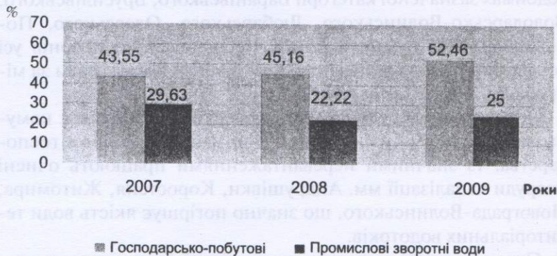
Рис. 4. Частка кількості випусків господарсько-побутових та промислових зворотних вод, що скидаються у поверхневі водойми без очищення
