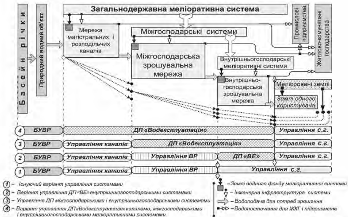
Рис. 6. Схема управління зрошувальними системами
