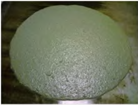
Рис. 1. Самоущільнювальна бетонна суміш
