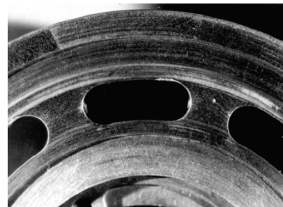
Рис. 4. Состояние кромок распределительных окон ( \times 2 ) блока цилиндров торцевого распределителя с разгружающей канавкой после 50 часов работы.
