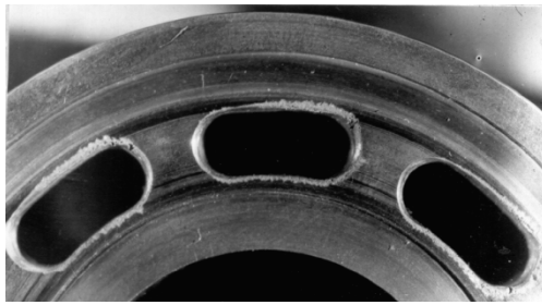
Рис. 1. Состояние кромок распределительных окон блока цилиндров после 50 часов работы (×2).
