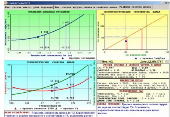
Рис. 5. Оценка технологической ситуации на основе контроля комплекса свойств конечного шлака в системе «Шлак»
