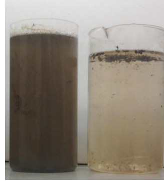
Рис.7. Вигляд фенольної води до (зліва) та після (справа) очистки
