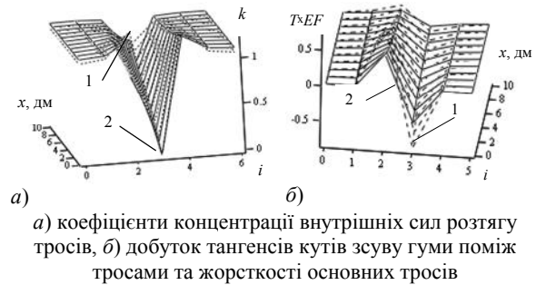
Рис. 1. Параметри напруженого стану гумотросової стрічки з uszkodженим середнім тросом
