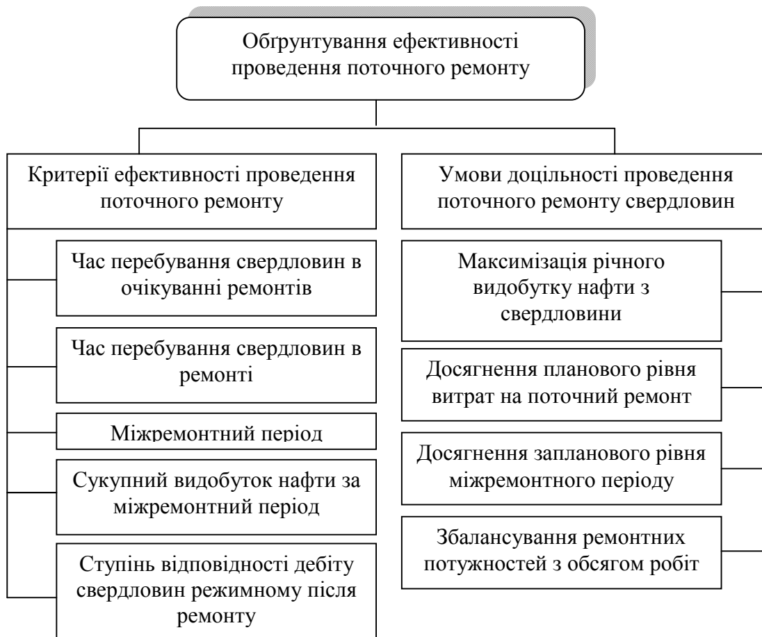
Рис. 2. Система показників ефективності проведення поточних ремонтів
