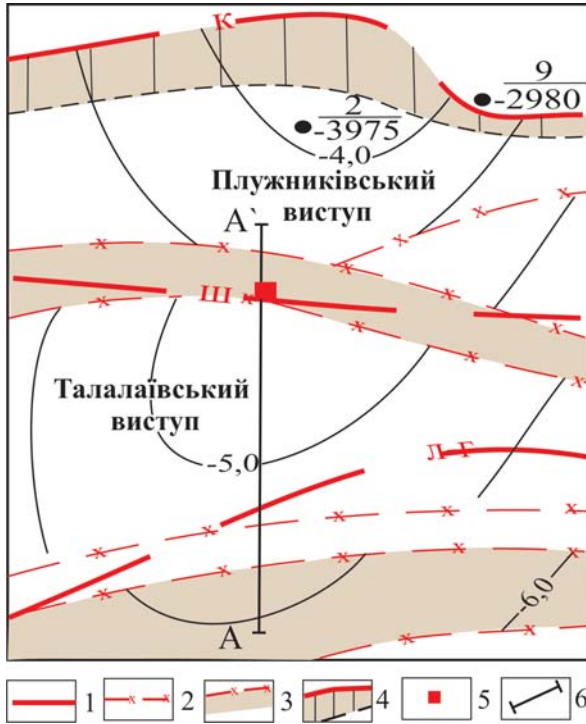
Рис. 3. Схематична структурна карта по покрівлі кристалічного фундаменту (за даними буріння та ДП "Укргеофізика"):
