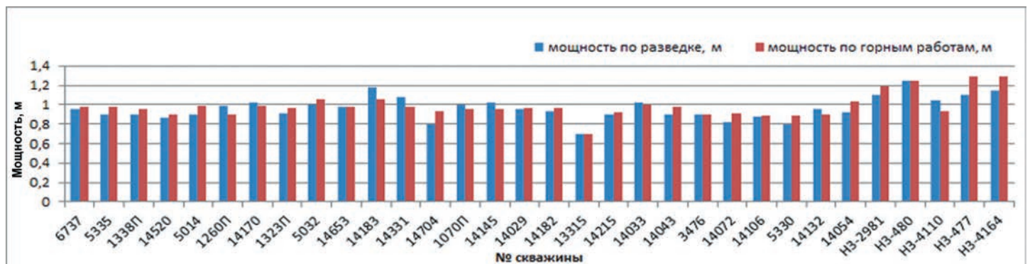
Рис. 4. Несоответствие мощностей по данным разведки и горных работ. Шахта “Юбилейная”
