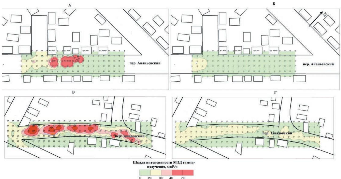
Рис. 3. Результаты детализации локальных аномалий МЭД гамма-поля в г. Кропивницком, площадная съемка по сети 5×5 м: А, В – до проведения дезактивационных работ; Б, Г – после проведения дезактивационных работ
