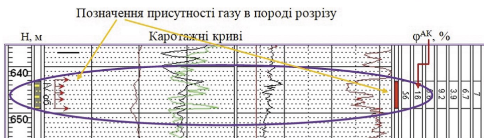
Рис. 9. Фрагмент каротажної діаграми з результатом промислових випробувань (угорі) і результат прогнозування за методикою (таблиця) для інтервалу 641–654 м розрізу свердловини 2-Зарічянської (за даними УкрДГРІ, 2015)
