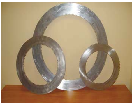
Рис. 2. Тормозные диски многодисковых маслоохлаждаемых тормозов карьерных самосвалов
