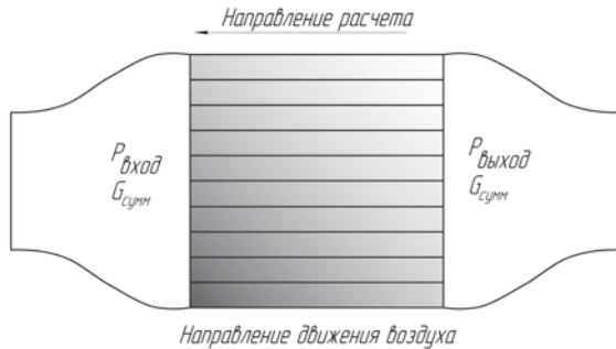
Рис. 4. Каналы теплообменника. (для примера, заливкой представлено распределение температуры воздуха)
