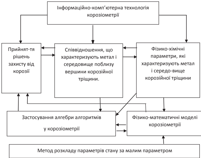
Рис. 2. Схема інформаційно-комп'ютерної технології з урахуванням корозійних процесів поблизу вершини тріщини
