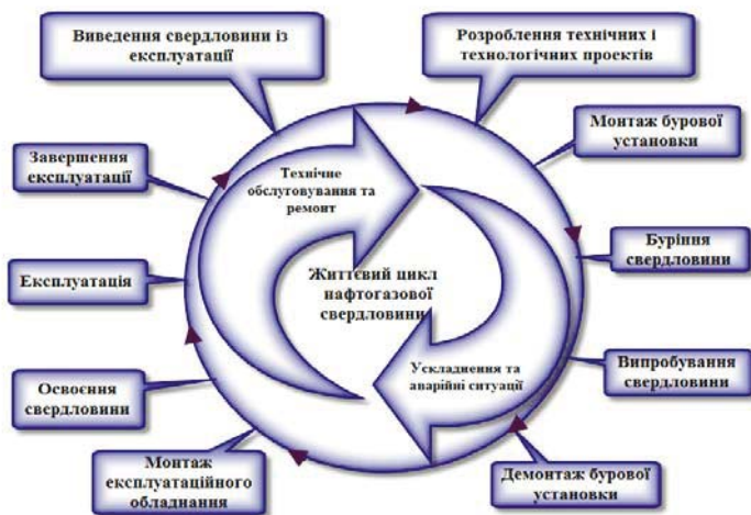
Рис. 1. Життєвий цикл нафтогазової свердловини
