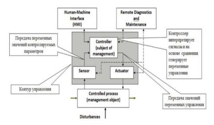
Рис. 2. Модель базовых операций индустриальных систем управления
