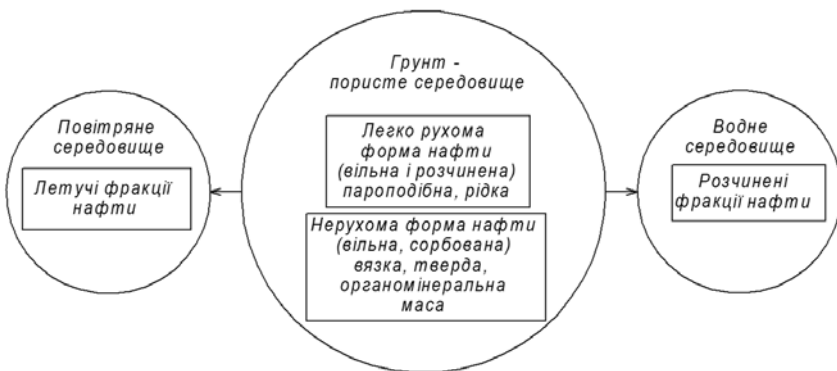
Рис. 1. Міграція нафти при аварійному розливі
