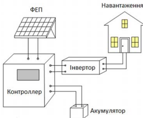
Рис. 1. Приклад автономної системи енергопостачання
